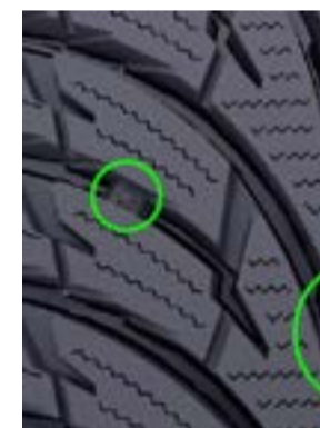
Индикаторы износа на зимней покрышке. По мере стирания сначала исчезает цифра 8, за ней — 6. Когда сотрется цифра 4, нужно прекратить зимнюю эксплуатацию шин.
