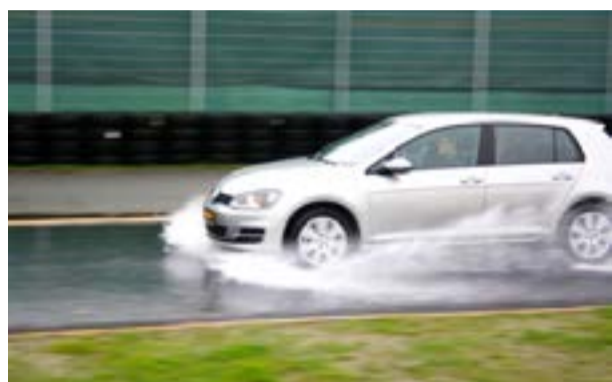
Golf на грани срыва в аквапланирование: водяной клин уже сформировался перед передними колесами.
